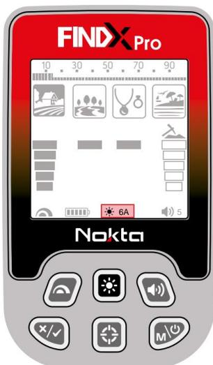
Para mudar de iluminação contínua para nível de iluminação automático, basta manter pressionado o botão Display LCD e luz de fundo do teclado.
