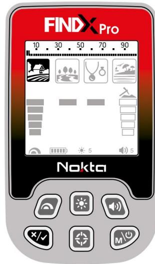
A configuração Notch Discrimination é restaurada para a configuração final salva quando o dispositivo é desligado e ligado novamente. Esta configuração é específica do modo; as alterações feitas em um modo não se aplicam aos outros modos.
