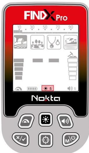
Varia de 0-5 e 6A-10A. No nível 0, a luz de fundo do display e do teclado está desligada. Entre 1-5, permanece continuamente ligado. Quando definido entre 6A-10A, acende apenas por um curto período quando um alvo é detectado ou um botão é pressionado e depois desliga.
